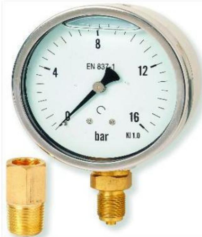
Verificar **MENSUALMENTE** el estado de los manómetros y verificar Calibración. Diferencia  $> \pm 3\%$  reemplazar.
